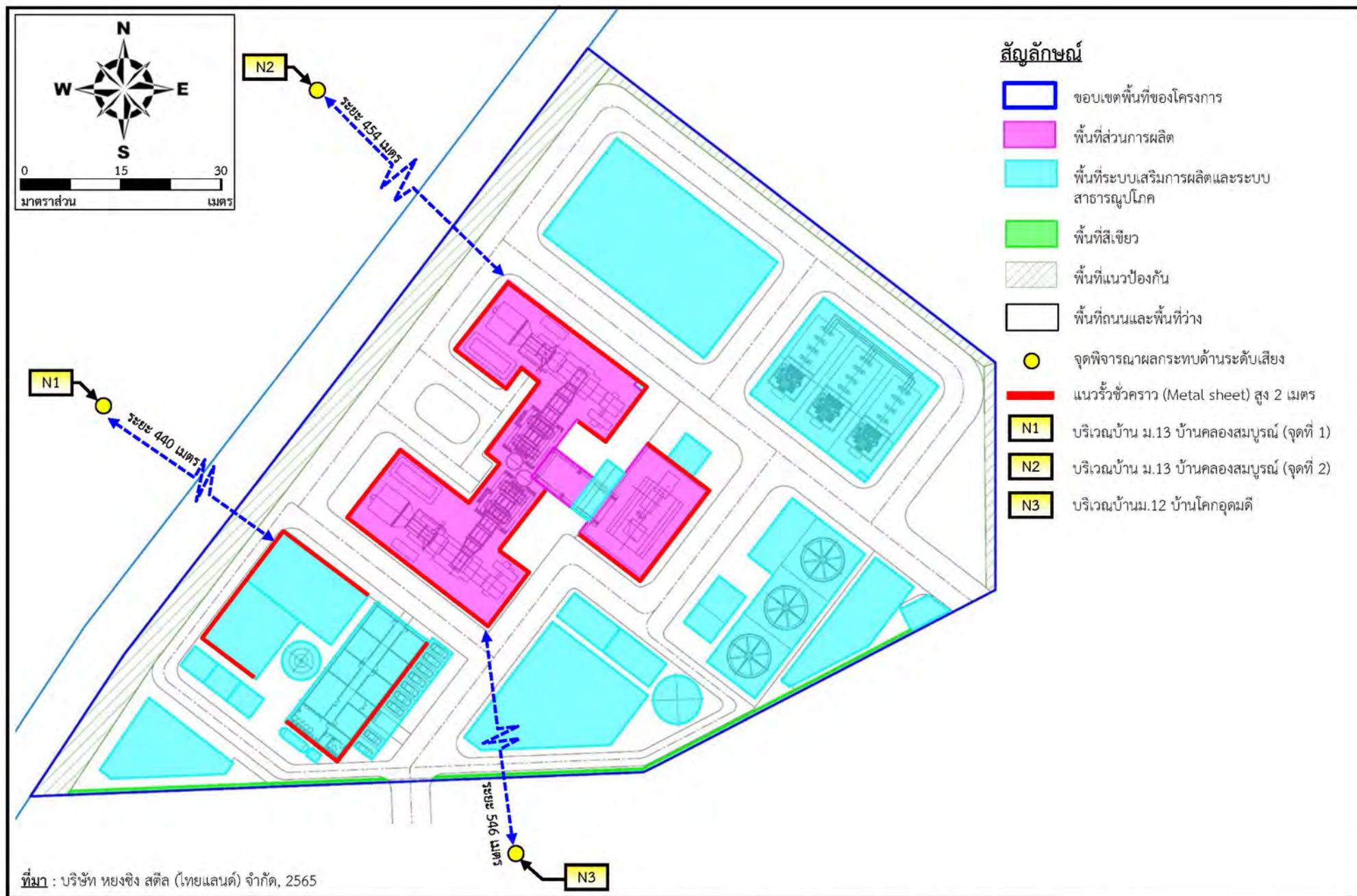
รูปที่ 5.2.3-3 บริเวณกลุ่มบ้านที่เป็นจุดพิจารณาและตำแหน่งติดตั้งรั้วชั่วคราวเพื่อลดผลกระทบด้านระดับเสียงช่วงก่อสร้างโครงการ
